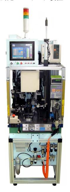
この設備はピストンの外径・ピン穴径を自動で測定し、測定したデータから外径寸法グレード、品番等をピストン頂面にマーキングする装置です。 全自動で全数検査が可能で、検査した製品のNO/ GO判定や外径グレード等の選別が可能です。
